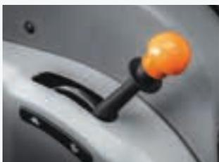
La palanca de accionamiento del superreductor está colocada ergonómicamente al alcance de la mano.
