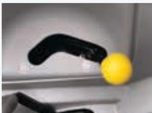
En los modelos Synchro Shuttle™ con cabina, la TDF se activa de forma eficaz con una palanca servoasistida situada ergonómicamente para facilitar su manejo.
