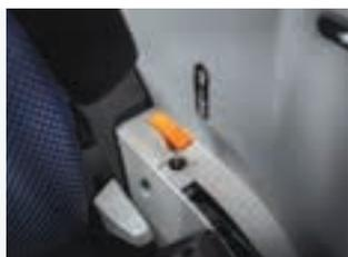
La palanca de selección TDF sincro con avance está ergonómicamente colocada a la altura de la mano.
