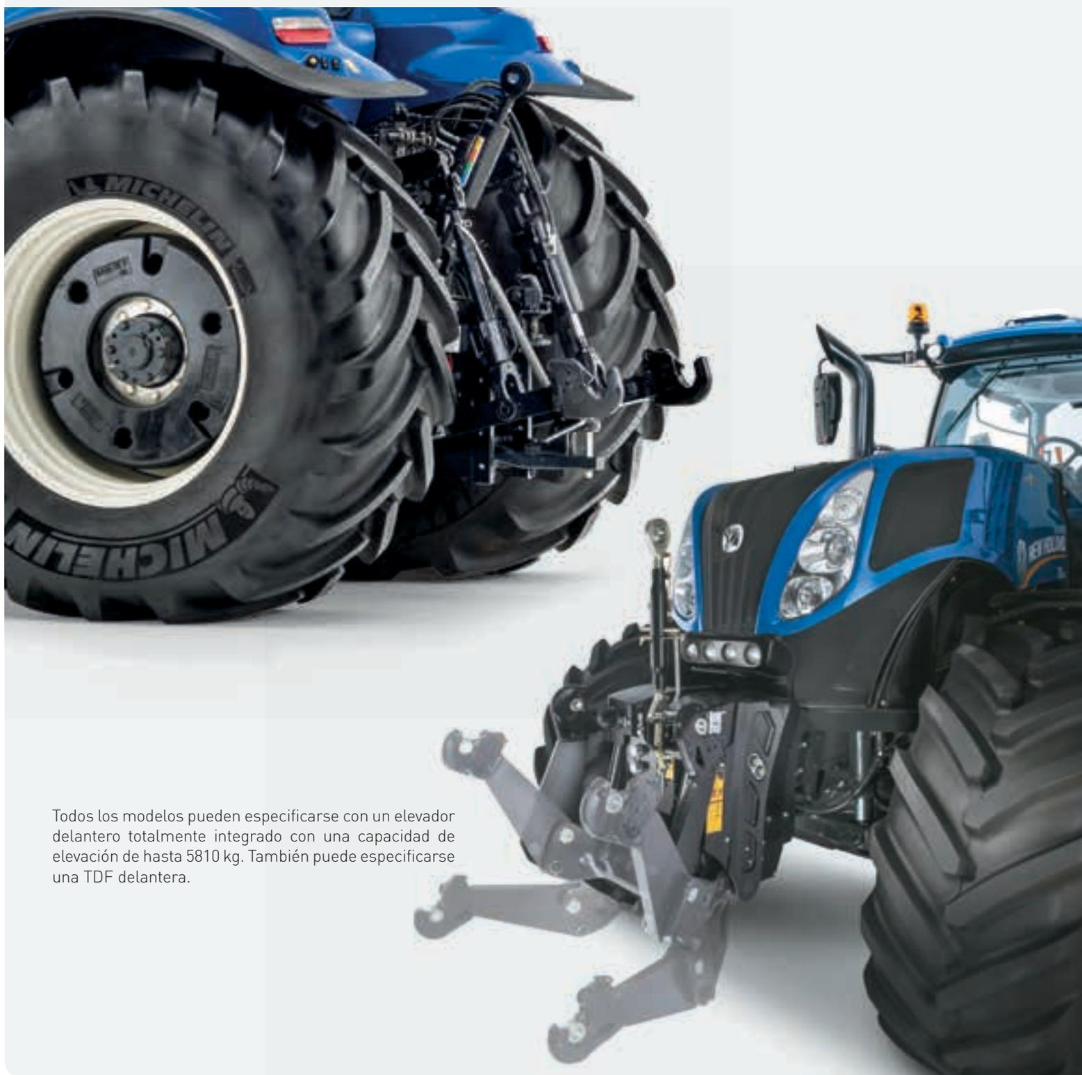
Todos los modelos pueden especificarse con un elevador delantero totalmente integrado con una capacidad de elevación de hasta 5810 kg. También puede especificarse una TDF delantera.
