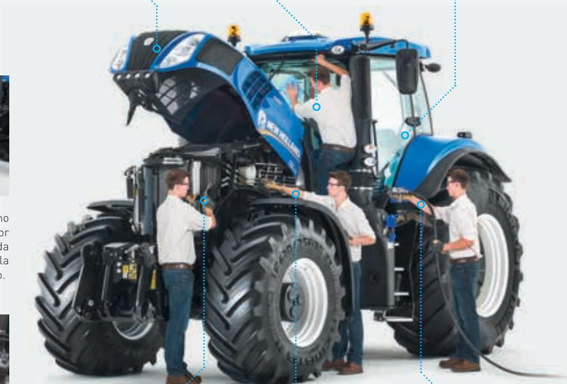
El sistema de refrigeración se abre para facilitar y agilizar la limpieza.
