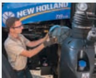
Compruebe, limpie o cambie el filtro de aire del motor sin tener que levantar el capó del motor.
